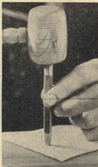
Fig. 38 - Per i fori più larghi, usare un punzone.
