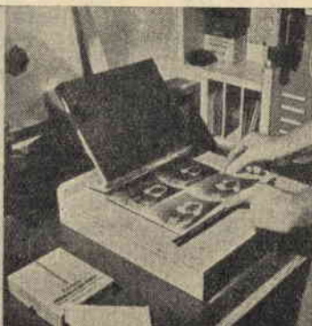
Fig. 6 - La stampatrice si presta benissimo per stampare contemporaneamente quattro negative 9x12.
