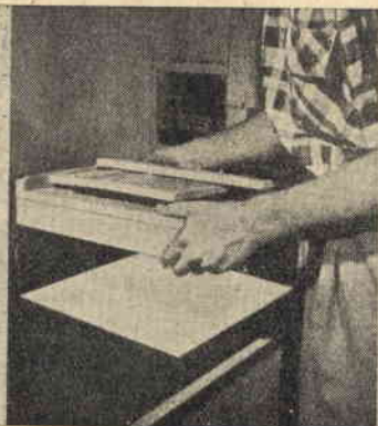
Fig. 2 - Il telaio della stampatrice si adatta perfettamente al vetro, lievemente sopraelevato.
