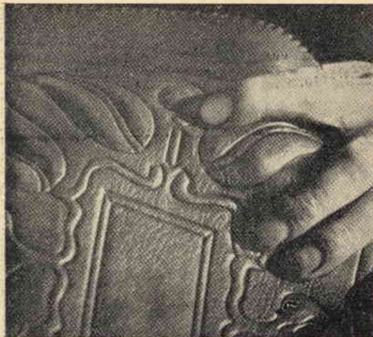
Fig. 15 - Stirare il cuoio dal rovescio. Notate come l'indice ed il medio accompagnano l'opera dell'utensile, tenendo ben teso il pezzo in lavorazione nel punto nel quale l'utensile stesso deve agire. Alcune volte può esser necessario tracciare il disegno anche sul rovescio, ma ciò non è sempre indispensabile, essendo di solito facile seguire l'azione dell'utensile
